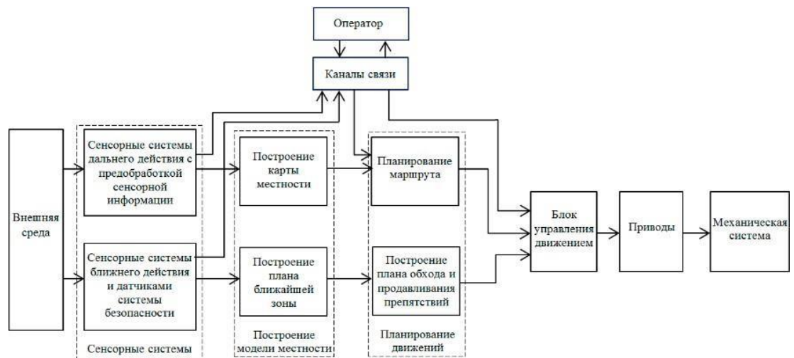
Рисунок 5 – Типовая схема системы управления перемещения мобильного робота.
