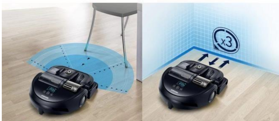
Рисунок 6 – Принцип работы датчиков робота пылесоса
